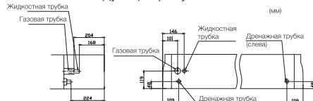
Положения соединений труб
